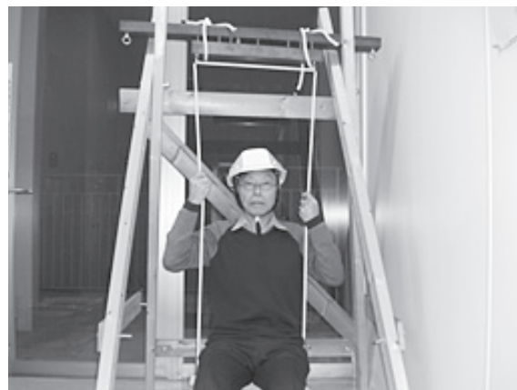
図-3 ニオブ磁石で人を吊り上げる 上部の鉄製建材の間に磁石がある
