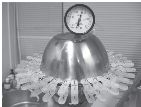
図-4 ステンレスボールで作った「マグデブルクの半球」。 洗濯ばさみは上下のボールの仮止め用である。
